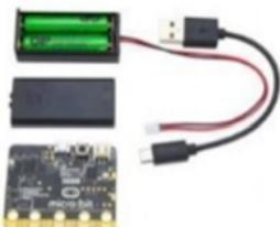
Micro:bit uređaj je edukativni mikroračunar koji ima 32-bitni procesor, senzore, ekran od 25 LED dioda i konektori, pet ulaza i izlaza (I/O) koji se koriste za povezivanje micro:bita s drugim uređajima ili senzorima, Bluetooth podršku, mogućnost programiranja i napajanje s dvije AA baterije.
